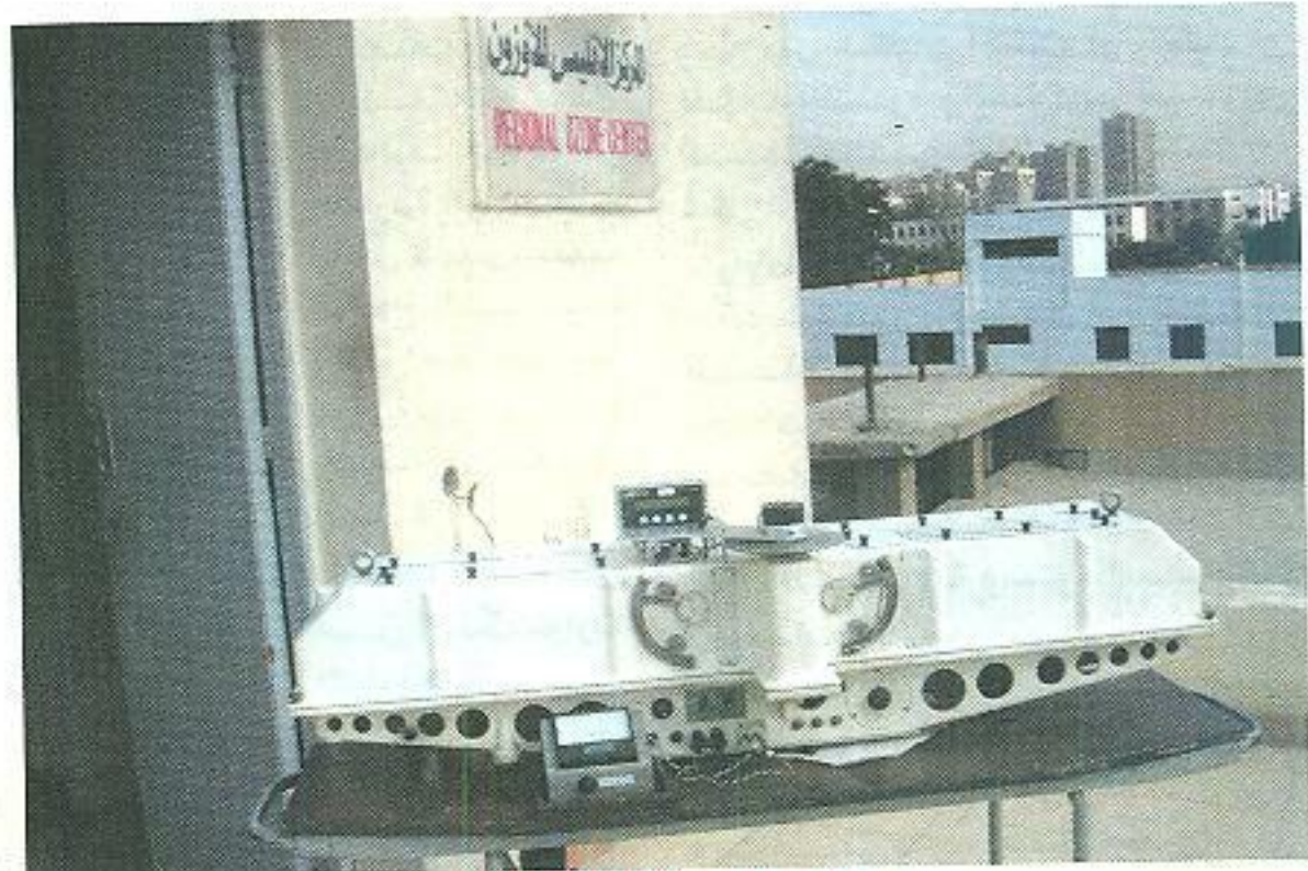
جهاز دوبسون لقياس الأوزون
