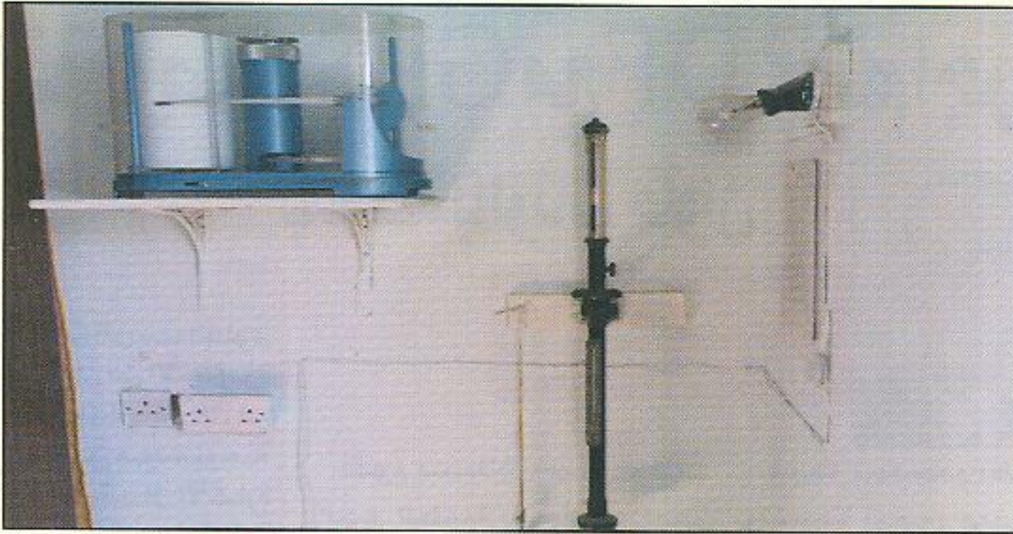
الشكل رقم (١٨) يوضح جهاز قياس الضغط الجوي البارومتر، وجهاز مسجل الضغط الجوي الباروجراف
