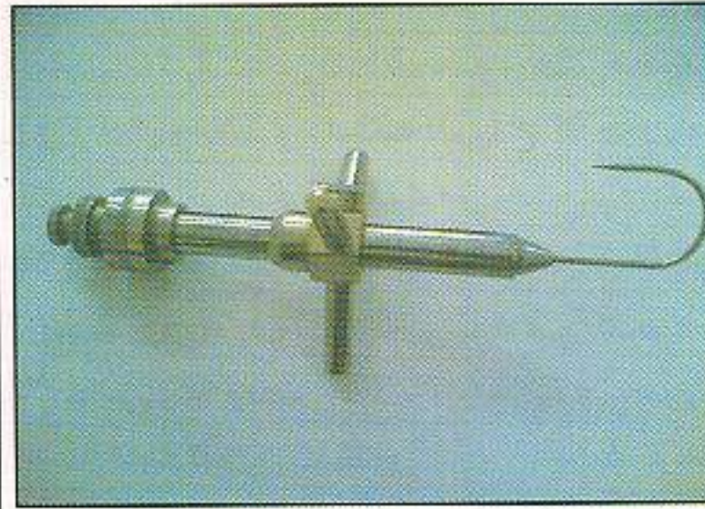
الشكل ٦ يمثل الميكروميتر وهو مصنوع من النحاس الأصفر الغير قابل للصدأ.
