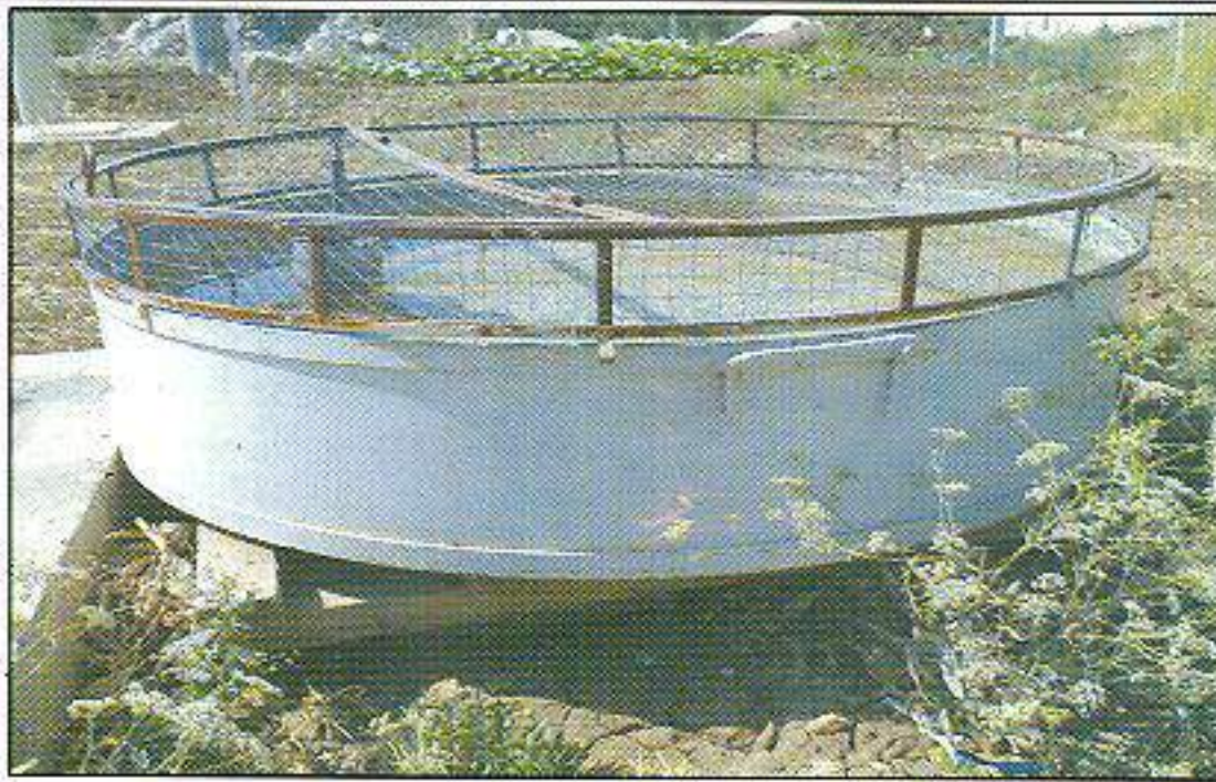
الشكل رقم (٤) وهو عبارة عن الوعاء القياسي المستخدم في قياس كمية التبخر ويلاحظ انه مغطى بغطاء شبكي لمنع الطيور والدواب من الشرب حتى تكون كمية التبخر المقاسة دقيقة
