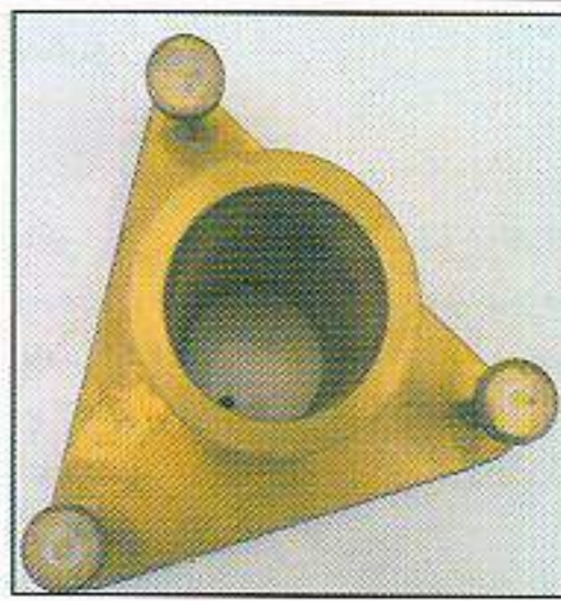
الشكل رقم (٥) يمثل البئر الساكن ويوضع داخل الوعاء القياسي ويتم ميزانه بواسطة المستامير الثلاثة حتى يكون مستو تماما، كما يلاحظ ان في أسفله فتحة تسمح بمرور الماء الموجود بالحوض ويكون في نفس مستوى الماء الموجود بالحوض طبقا لنظرية الأواني المستطرقة، وتم تصميم البئر الساكن بحيث لا يحدث به أي تموجات عنيفة حتى ولو كانت موجودة بباقي الوعاء
