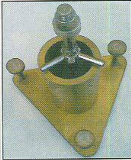
الشكل ٧ يمثل طريقة وضوع الميكروميتر داخل البئر الساكن ويتم وضع الاثنان مجتمعين داخل حوض الوعاء القياسي.
