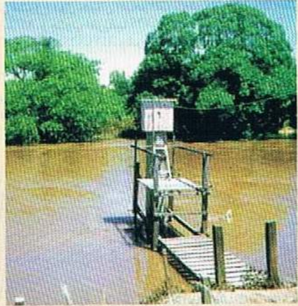
Data collection platform (DCP) (شكل ١) :منصات تجميع بيانات الهيدرولوجي تركيب قريبة من مصبات الأنهار ومخزرات السيول والأمطار
