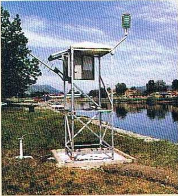
Data collection platform (DCP) (شكل ١) :منصات تجميع بيانات الهيدرولوجي تركيب قريبة من مصبات الأنهار ومخزرات السيول والأمطار
