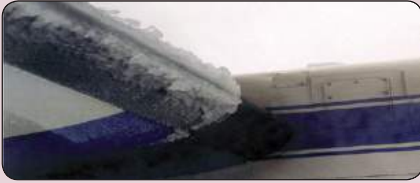
صورة توضح تراكم الجليد على اجنحة الطائرة
